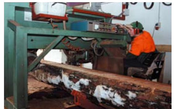
Mit der hofeigenen Säge schneidet Raimund die Lärchenbretter
