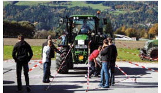
Mit Absperrbändern sichtbar gemacht wurde der „Tote Winkel“ und die damit verbundenen Gefahren beim Betrieb des Traktors
