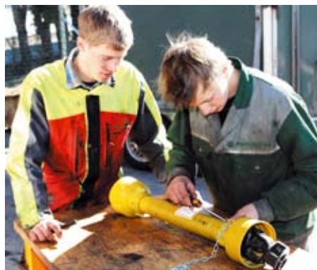
Florian Preßlaber unterstützt Georg Wibmer beim Ablängen einer Zapfwelle
