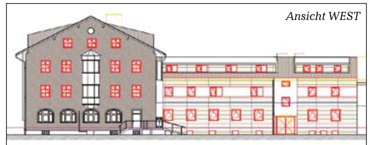
Der Verbindungstrakt (rechts) wird aufgestockt und ausgebaut.
