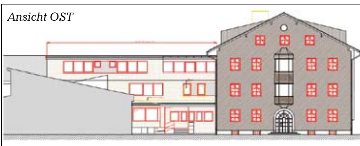
Im Altbestand (denkmalgeschützt) werden Lärchenfenster eingebaut.
